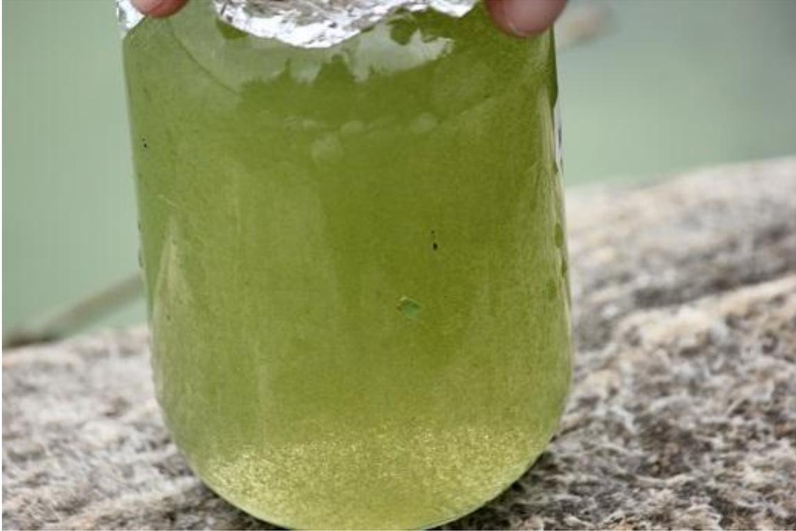
**Figure 5 : Échantillon d'eau contenant 2 000 000 cellules/mL de cyanobactéries**
